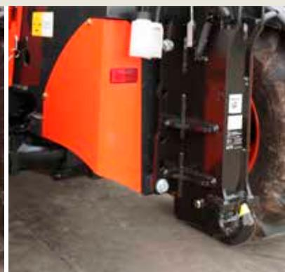
Hydraulisch Anhängerkupplung mit hydraulischer Verriegelung
