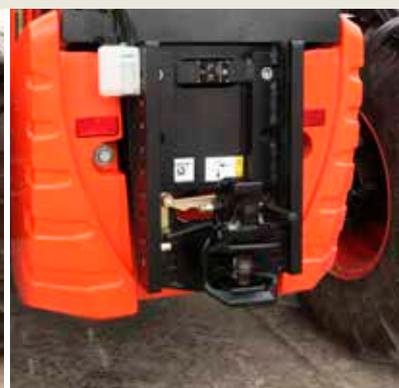
Drehbare Anhängerkupplung mit Höheneinstellung
