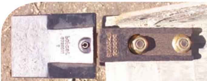
Der 102 mm breite Hensley Schaufelzahn mit zusätzlicher Oberflächenhärtung verringert den Verschleiß der Schaufel- und Seitenschneiden.
