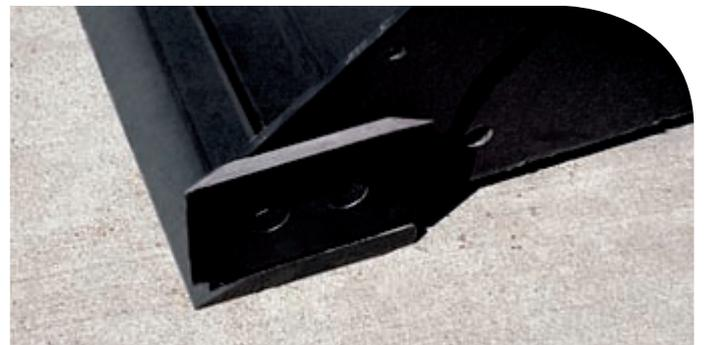
Die Schaufelecken unterliegen besonders dem Verschleiß. Durch das Anschrauben der Eckschneiden erhöhen Sie die Lebensdauer Ihrer Schaufel erheblich. Die meisten Bobcat Schaufeln haben hierfür bereits vorgebohrte Löcher.
